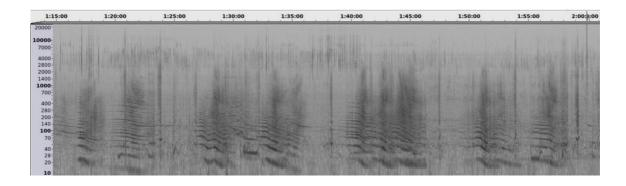
On y distingue les signatures sonores des hélicoptères, caractérisée par une forme typique ressemblant à un « conifère », s'étalant sur une gamme de fréquence entre 15 et 2000 herz.
