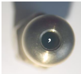
Le gicleur partiellement bouché
